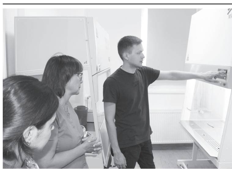
Данное оборудование входит в базовую комплектацию ПЦР-лаборатории и обеспечивает в первую очередь защиту сотрудников от возможного инфицирования при работе с патогенными микроорганизмами.
